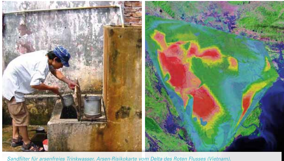
Sandfilter für arsenfreies Trinkwasser. Arsen-Risikokarte vom Delta des Roten Flusses (Vietnam). Filtration de l'arsenic contenu dans l'eau potable. Carte des risques de pollution dans le delta du fleuve Rouge (Viêt Nam). Sand filter for removing arsenic from groundwater. Arsenic risk map for the Red River Delta in Vietnam.
