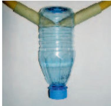
Kondenswasser muss entfernt werden, damit die Gasleitung nicht blockiert wird: Vorschlag für einen einfachen Abscheider.
