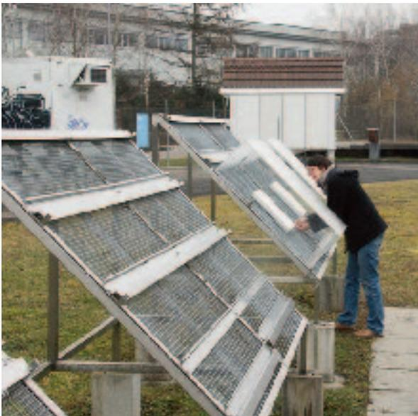
Fassadenpaneele, deren Anstrich Silbernanopartikel enthält, werden der Witterung ausgesetzt. Das abfliessende Regenwasser wird aufgefangen und mit Hilfe der Bachflohkrebse ökotoxikologisch beurteilt. Überwacht werden insbesondere Auswirkungen auf Schwimmaktivität und Atmung.
