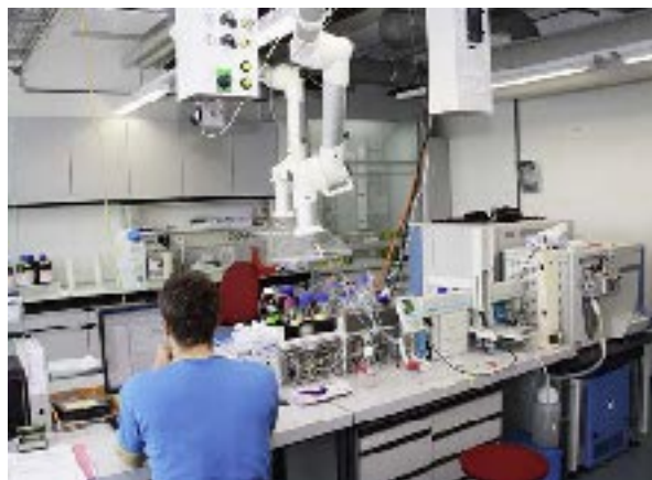
Oben: Baugrube und Fundierung der Stabilisierungselemente für die Gewährleistung der Erdbebensicherheit; unten: Renoviertes Labor, neu mit Mediensäule und Punktabsaugeneinrichtungen.
