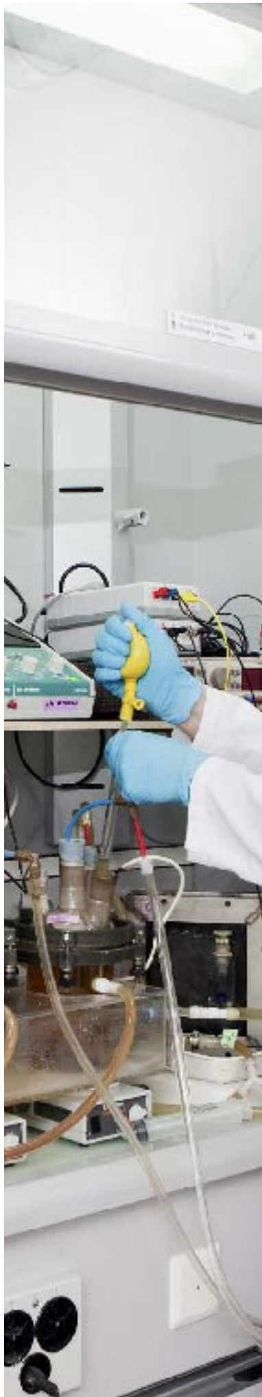
Umschlag Verfahrenstechniker Kai Udert erforscht an der Eawag, wie dezentrale Verfahren künftig für die Behandlung von Urin eingesetzt werden könnten – im Bild eine mikrobiologische, mit Urin beschickte Brennstoffzelle (siehe auch Seite 28). Foto: Stefan Kubli, Zürich
