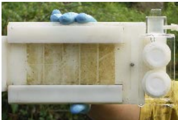
Probenahme mit Algen auf Glasplättchen und mit zwei Metall-Passivsammlern direkt im Bach.
