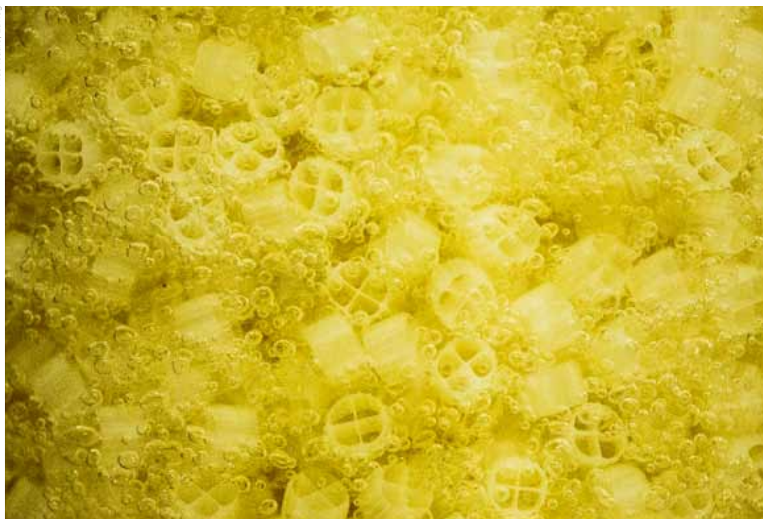
Post-traitement biologique en réacteur à lit fluidisé: la surface des matériaux synthétiques est colonisée par des organismes qui dégradent les composés organiques encore présents dans les eaux usées traitées.
