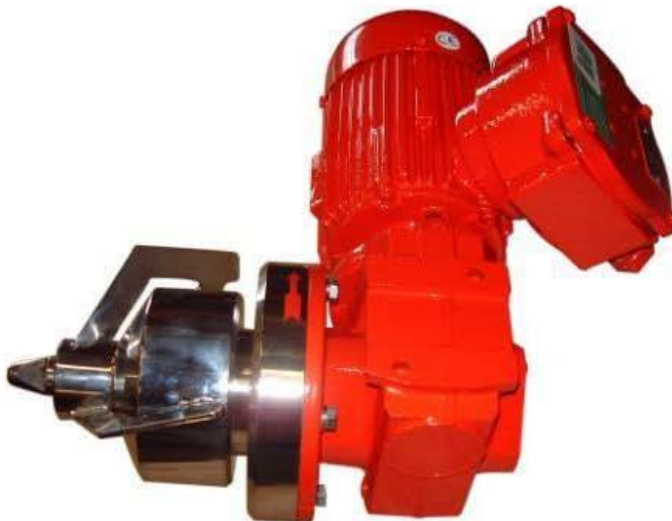
Magnetrührwerk in Ex-Ausführung
