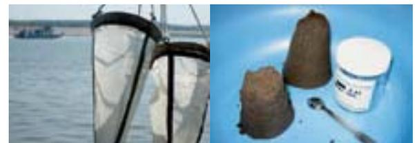
Über Nacht wurden solche Netze der Strömung ausgesetzt, um suspendierte Partikel zu sammeln. Im Labor wurden die Proben dann auf Schwermetalle, Nährstoffe und organische Industriechemikalien untersucht.
