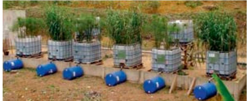
Aufbau eines bepflanzten Vererdungsbeetes mit Sand- und Kiesfilterschichten. Das abfließende Schlammwasser wird in diesem Beispiel in eine Kläranlage geleitet.
