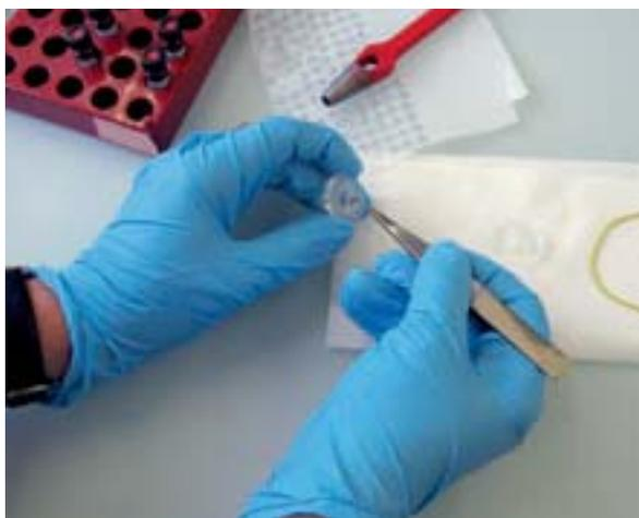
Einsetzen der Rührscheibe in die eine Hälfte der Glaszelle. Die ganze Glaszelle mit der PDMS-Membran in der Mitte kommt dann auf einen Magnetrührer, bei dem die Rührscheiben nicht nur gedreht, sondern auch gestürzt werden. So bleibt an der Kiemenmembran nur eine hauchdünne Wasserschicht ungerührt.
