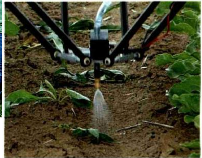
Eine Kamera erkennt das Unkraut und behandelt es gezielt mit einem Herbizid. Für den Biolandbau gibt es eine Version mit einer Fräse.
