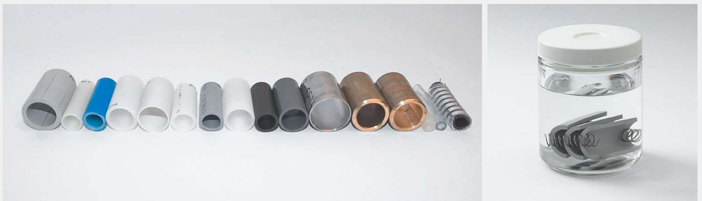
Fig. 1 Beispiele unterschiedlicher Rohrleitungsmaterialien, deren Einfluss auf die Trinkwasserqualität mit dem Materialtest BioMig getestet wurden. Exemples de matériaux de conduites divers et variés, dont l'influence sur la qualité de l'eau potable a été testée à l'aide du test de matériaux BioMig.
