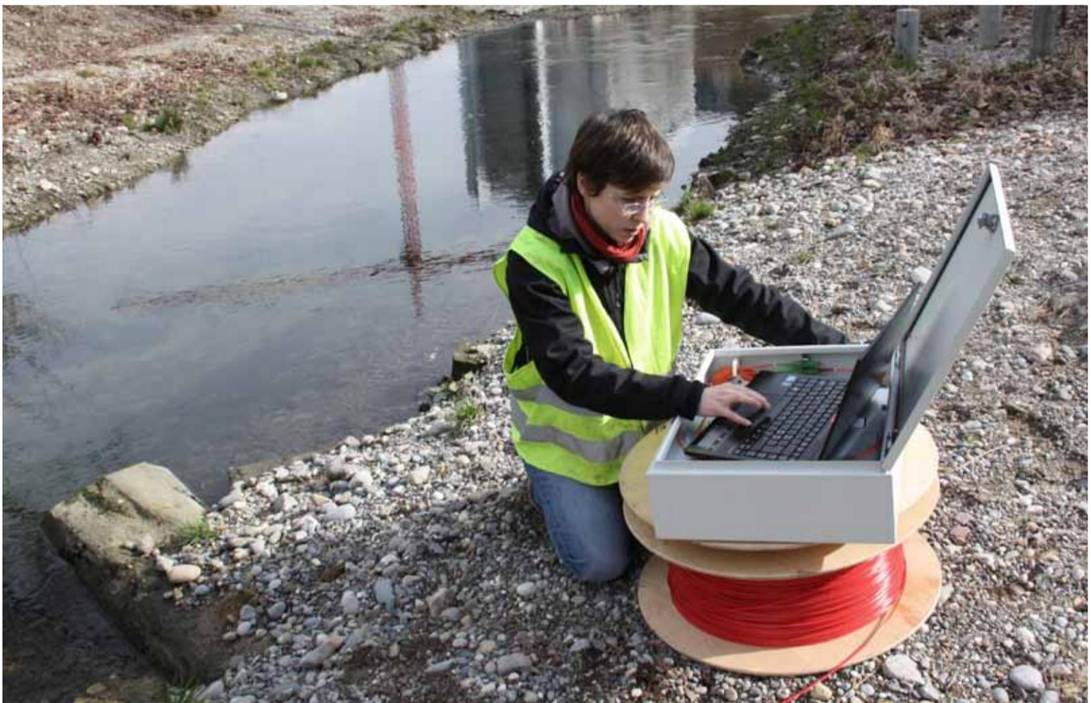
Fig. 1: La chercheuse de l'Eawag Anne-Marie Kurth au bord du Chriesbach (ZH) juste après les travaux de revitalisation. La méthode innovante qu'elle emploie fait appel à un câble de fibre optique enfoui dans le fond du lit des cours d'eau.
