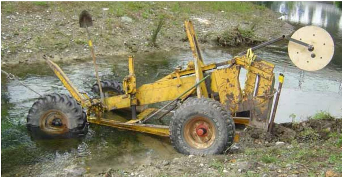
Fig. 2: Engin spécialement conçu pour enfouir le câble dans le fond du lit.
