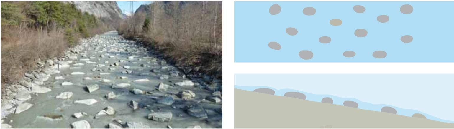
Fig. 2c: Différents types de rampes en enrochement: Rampe en enrochement disjoints non structurés
