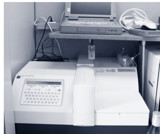
Im Luminometer wird die Stärke der Lichtemission und damit die Belastung der Wasserproben mit Arsen bestimmt.
