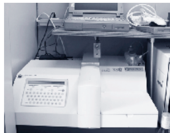
Le luminomètre permet de mesurer l'importance de la contamination des échantillons d'eau par de l'arsenic.
