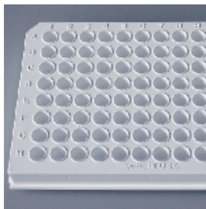
Les cellules sont transférées dans une plaque de microtitration renfermant différents échantillons d'eau.
