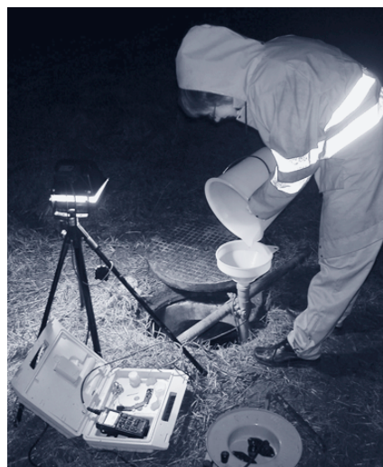
Exfiltrationsexperiment: Zugabe der NaCl-Lösung als Referenzsignal.
