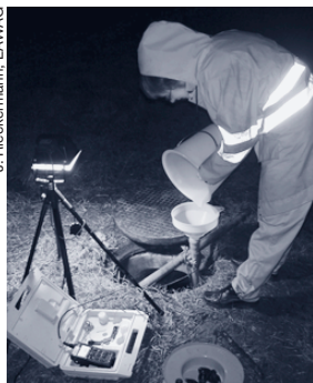
Essai «Exfiltrations»: apport d'une solution de NaCl comme signal de référence.
