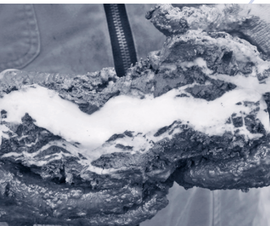
De l'hydrate de méthane confiné dans un échantillon de sédiment marin.
