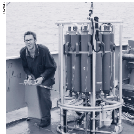
Pour remonter les échantillons d'eau à la surface, on se sert d'un appareil pourvu de 12 bouteilles pouvant être refermées à différentes profondeurs depuis le bateau.
