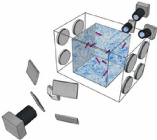
Im Laborsetting erfassen Kameras die Teilchenbewegung in transparenten, mit Wasser gefüllten Messkästen. Fasern sind dabei vorteilhafter als Kügelchen. (Bild: Holzner Lab / Environmental Fluid Mechanics – EFM)
