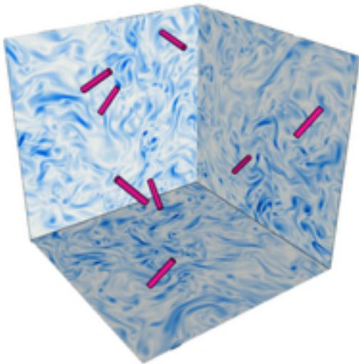
Mit der neuen Methode reicht es, die Bewegungen von wenigen starren Fasern zu verfolgen, um die gesamte Dynamik von Wirbeln erfassen zu können. (Bild: Holzner Lab / Environmental Fluid Mechanics – EFM)
