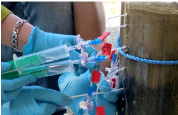
Anhand von Biomarkern und der Atmung der Mikroben werden die Sedimentkerne untersucht. (Foto: ETH, Annika Fiskal)
