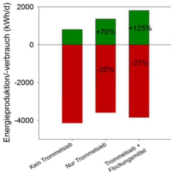
Berechneter Energieverbrauch und –produktion auf der ARA Sihltal – ohne Trommelsieb, mit
