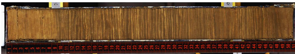
*Dieses Stück des Sedimentbohrkerns zeigt den Abschnitt mit den römischen Warven. Jeweils eine helle und dunkle Schicht ergeben zusammen ein Jahr. (Foto: Eawag)*
