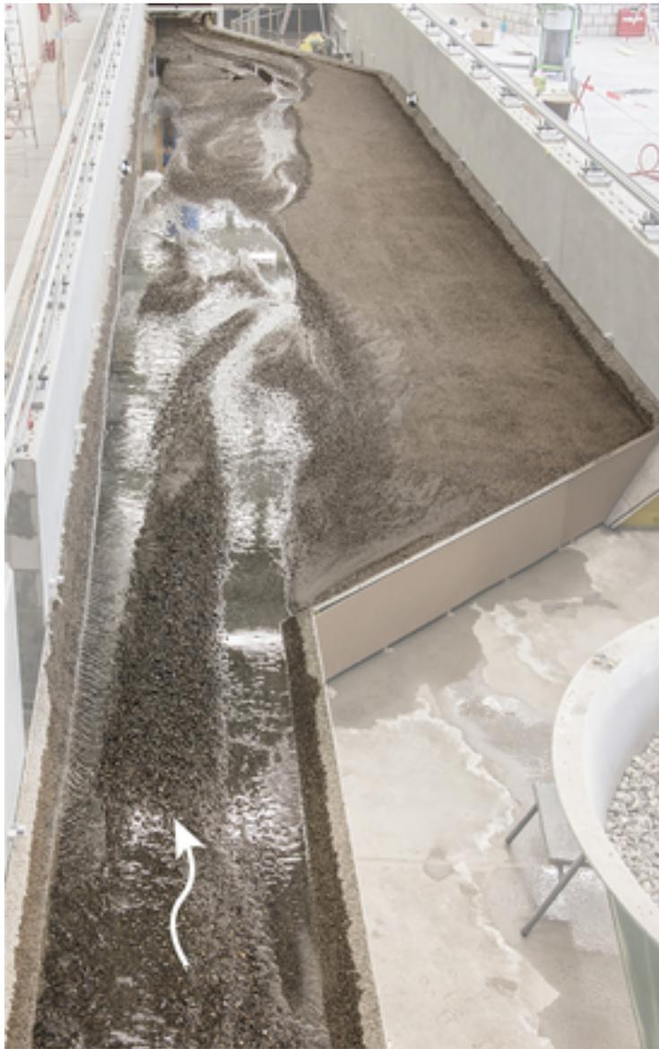
**Diese dynamische Flussaufweitung an der Kander diente als Referenzabschnitt für die Laborversuche zur Untersuchung des Einflusses unterschiedlicher Geschiebezufuhr auf die Entwicklung der Aufweitung. (Luftbild: Bundesamt für Landestopografie swisstopo, Foto: VAW, ETH Zürich)**
