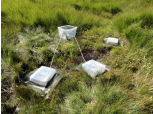
Versuchsanordnung zum Auffangen der gasförmigen Spurenelement-Emissionen
