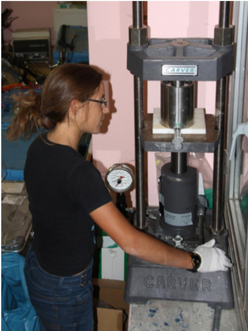
Mit bis zu 170 bar Druck wird das Porenwasser aus den Proben gepresst.
