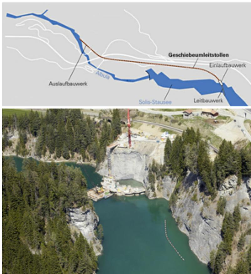
Bis zum Bau des Umleitstollens lagerte die Albula pro Jahr rund 80'000 Kubikmeter Geschiebe im Solis-Stausee ab, sodass dieser etwa die Hälfte seines ursprünglichen Volumens einbüsste.
