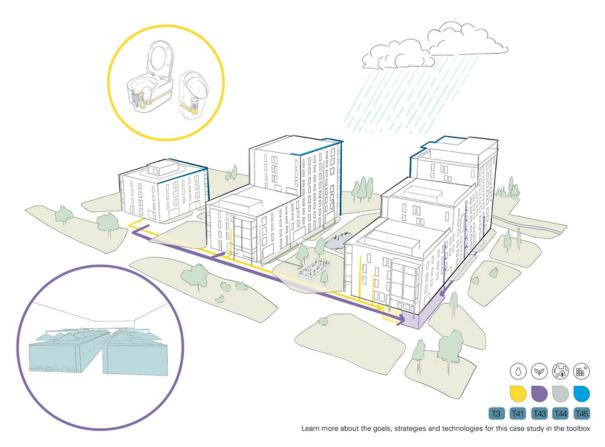
"La Bistoquette" ist eine Genossenschaftssiedlung in Genf mit Wohnungen für 330 Personen. Die verschiedenen Abwasserströme werden getrennt, im Keller oder im Aussenbereich aufbereitet und zusammen mit gesammeltem Regenwasser für die Toilettenspülung verwendet. Der Urin wird separat gesammelt, um einen Flüssigdünger herzustellen. (Bild: Rosanne Wielemaker, Eawag)
