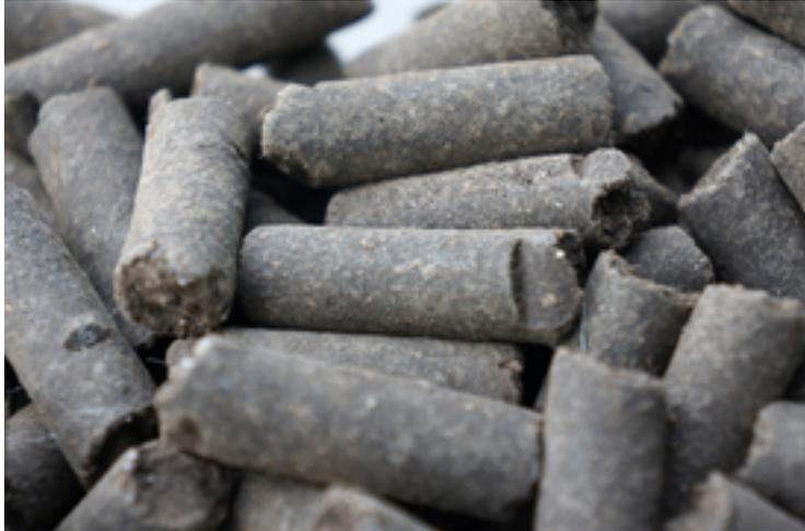
Mit Pellets aus entwässertem Fäkalschlamm werden in Senegal und Uganda Brennöfen befeuert.
