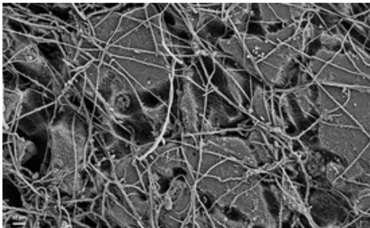
**Elektronenmikroskopieaufnahme der Oberfläche eines PBS-Films nach sechswöchiger Inkubation im Boden: Die Oberfläche des PBS ist durch besiedelte Pilze und Bakterien bereits merklich abgebaut. (Bild: Michael Zumstein)**
