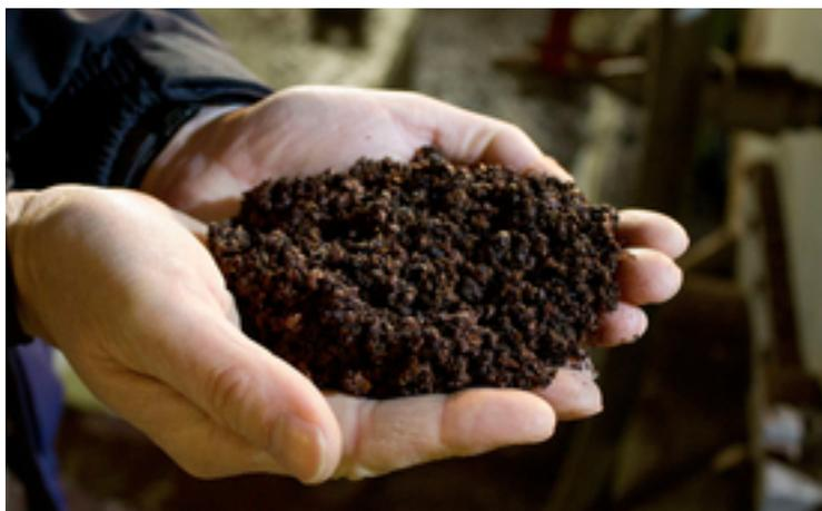
*Aus dieser Klärschlammasche kann ein schadstofffreier Phosphordünger hergestellt werden. Damit können regionale Phosphorkreisläufe geschlossen werden.*
