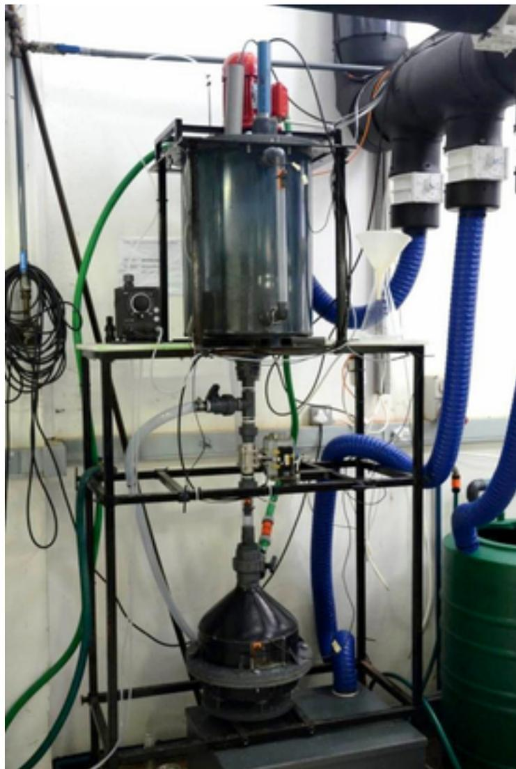
*Automatisierte Fällung des Minerals Struvit aus Urin in einer Kooperation der Eawag mit der University of KwaZuluNatal in Südafrika. Struvit kann als Phosphordünger eingesetzt werden. (Foto: Eawag)*
