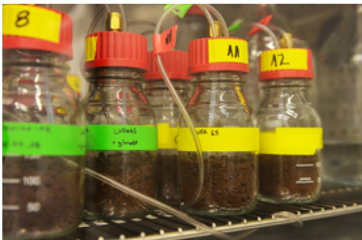
*Das Erdmaterial mit Folienstücken wird im Klimaschrank inkubiert. Mikroorganismen, welche die Folie abbauen, geben CO<sub>2</sub> ab, das kontinuierlich analysiert wird.*
