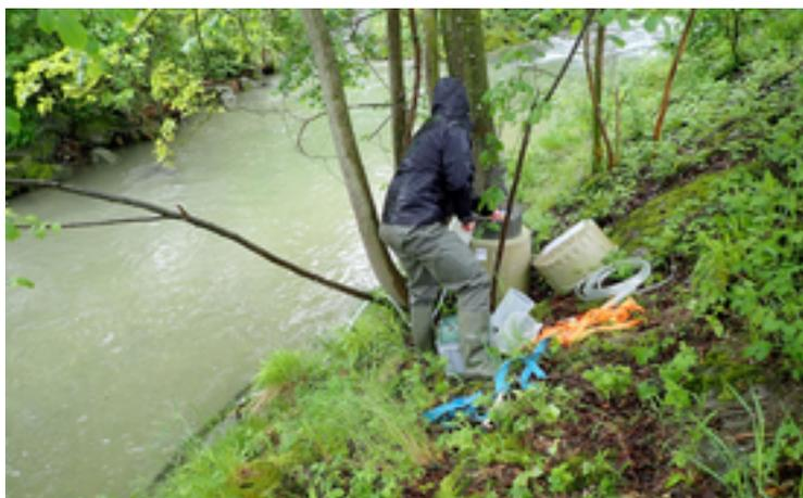
**Einsatz eines automatischen Probenehmers im Abwassereinzugsgebiet bei Regenwasserereignissen.
