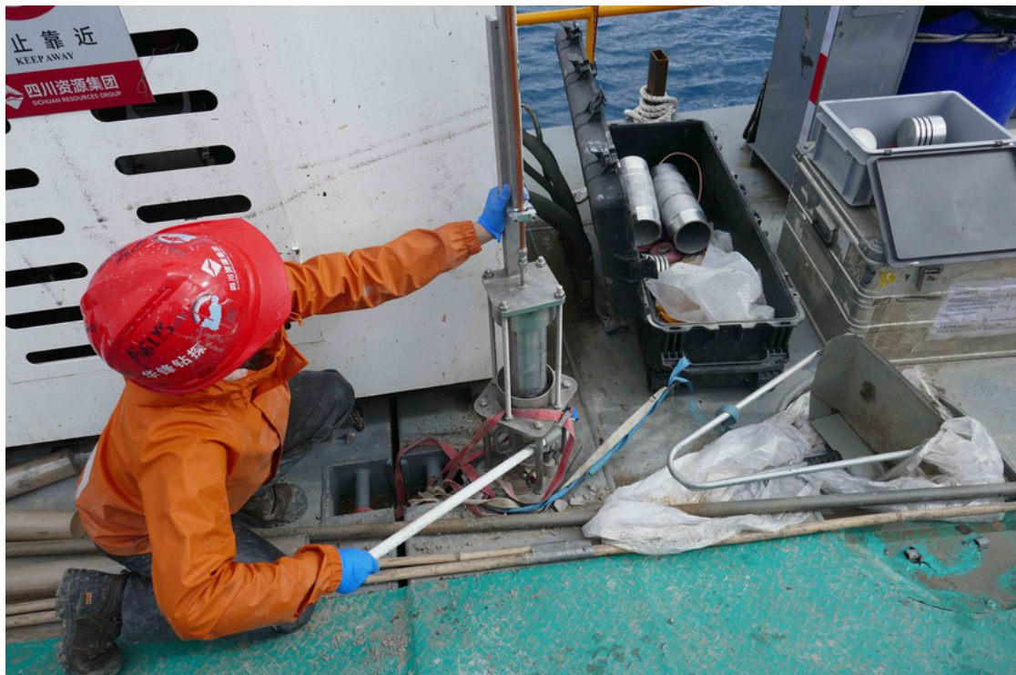
Mit dieser Presse wurde direkt auf der Bohrplattform auf dem Nam Co See Porenwasser
