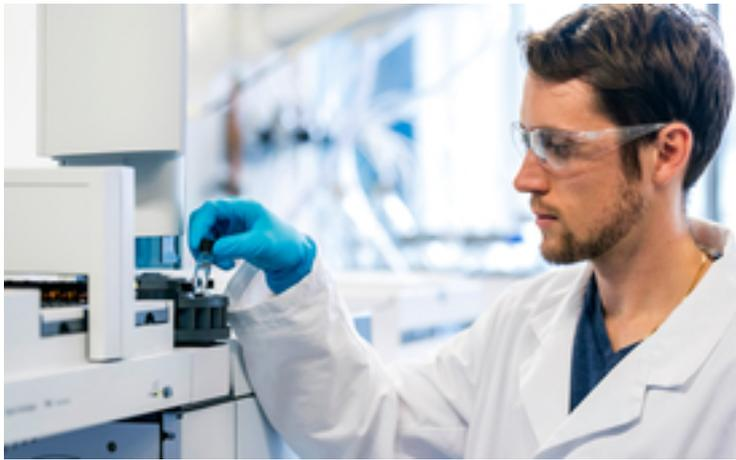
*Selektive und nachweisstarke Analyse der Pyrethroidinsektizide in den Probenextrakte mittels Tandem-Massenspektrometrie gekoppelt an die Gaschromatographie. Im Bild: Michael Patrick, Wissenschaftlicher Assistent, Abteilung Umweltchemie, Eawag.
