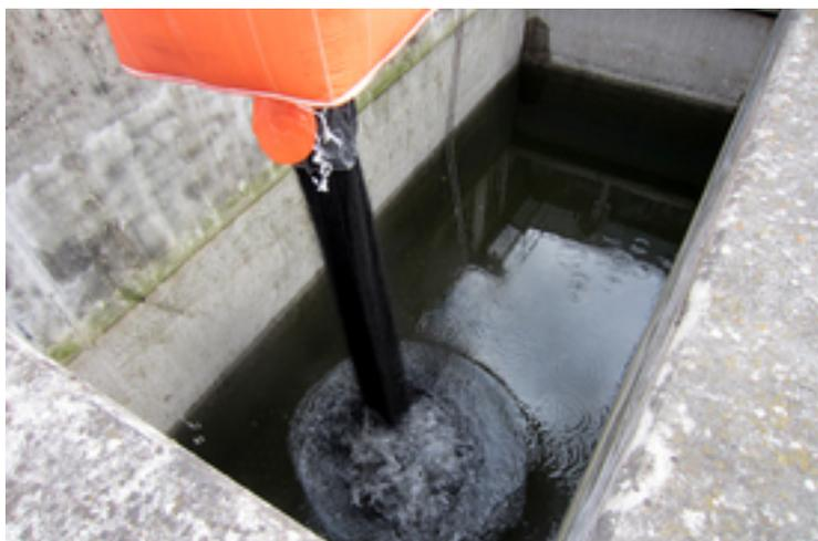
*Für Versuche der Eawag wird eine Sandfilterzelle der ARA Bülach statt mit Sand mit granulierter Aktivkohle beschickt.
