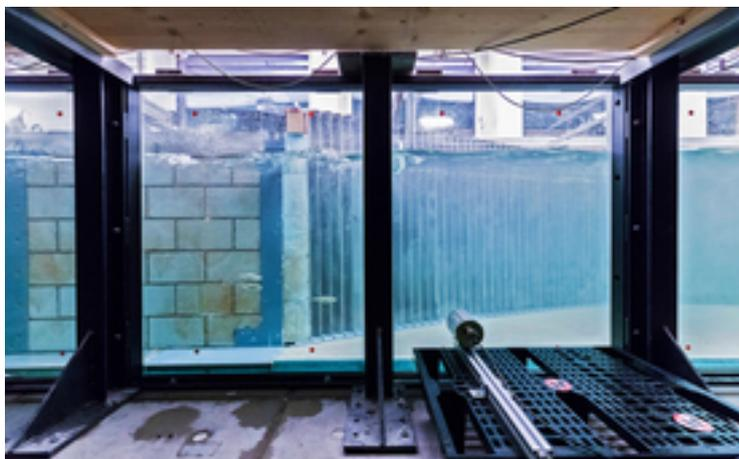
Schneider vor dem CBR-Fischleitrechen in der Versuchsanlage an der VAW. Der Kanal ist insgesamt 30 m lang, 1.5 m breit und 1.2 m tief.
