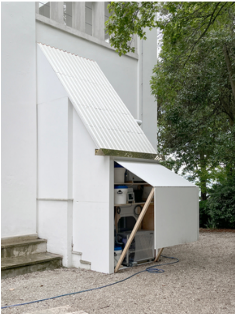
Der Nutrient Harvester gewinnt aus 30 Litern Urin rund 1 Kilogramm Trockendünger. (Foto: ARCH+SUMMACUMMFEMMER BÜRO JULIANE GREB)
