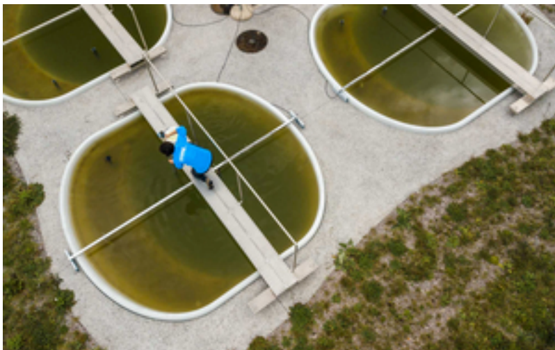
Anita Narwani entnimmt eine Wasserprobe aus einem der Versuchsteiche. (Foto: Thomas Klaper)
