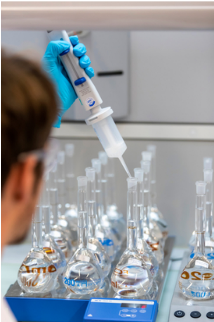
Selektive und nachweisstarke Analyse der Pyrethroidinsektizide in den Probenextrakte mittels Tandem-Massenspektrometrie gekoppelt an die Gaschromatographie. Im Bild: Michael Patrick, Wissenschaftlicher Assistent, Abteilung Umweltchemie, Eawag. Foto: Alessandro della Bella, Eawag
