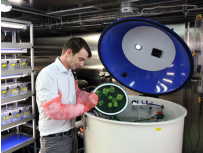
Im Fischraum der Eawag: Eine Laichschale wird in ein Becken eingesetzt, um Zebrafährblingseier für den FET-Test (Fisch Embryo Toxicity test) zu gewinnen. (Martin Lehmann)
