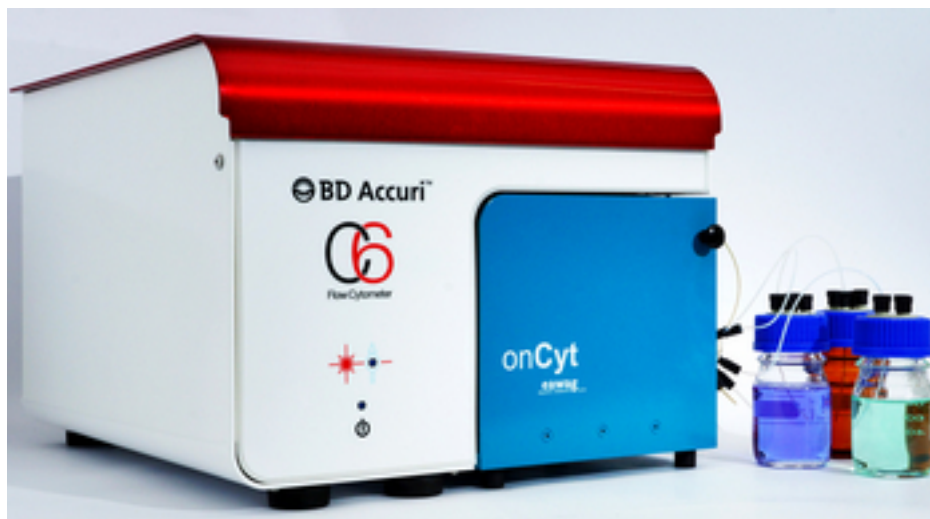
Abb. 2: Vollautomatisiertes Online-Durchflusszytometrie-System bestehend aus einem herkömmlichen Durchflusszytometer (rot-weiss) und dem von der Eawag entwickelten Automationsmodul (blau). Foto: Jürg Sigrist
