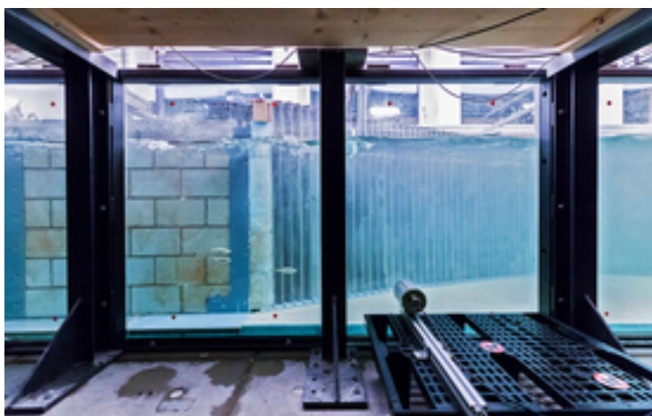
Schneider vor dem CBR-Fischleitrechen in der Versuchsanlage an der VAW. Der Kanal ist insgesamt 30 m lang, 1.5 m breit und 1.2 m tief. (Foto: VAW)
