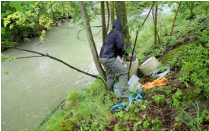
Einsatz eines automatischen Probennehmers im Abwassereinzugsgebiet bei Regenwasserereignissen. (Quelle: Eawag)
