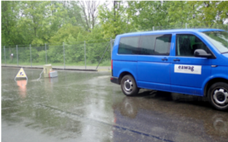
Beprobung des Abwasserüberlaufs bei Niederschlag in einer Kläranlage in Münchwilen, Thurgau, Schweiz. (Quelle: Eawag)
