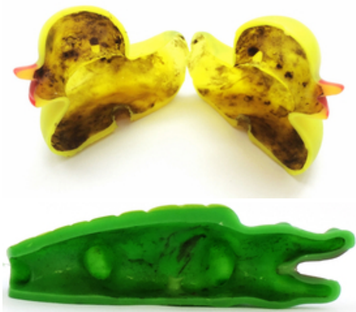
Das Innenleben eines Badekrokodils und eines Gummientchens. Bilder: Eawag.
