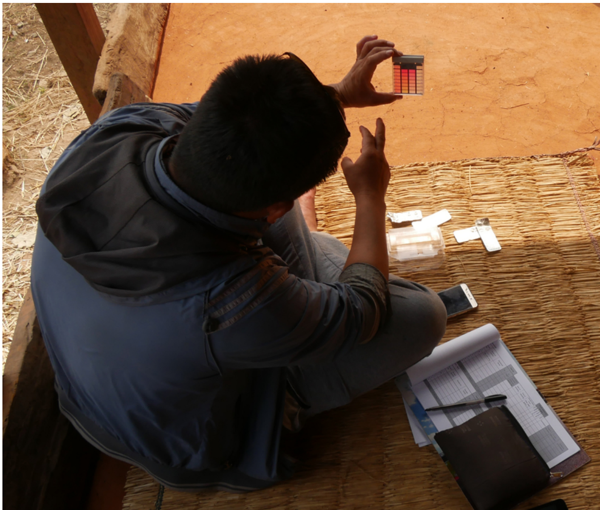
Test der Trinkwasserqualität in Nepal: Bestimmung von Chlorgehalt und pH-Wert (Foto: Michael Vogel, Eawag)
