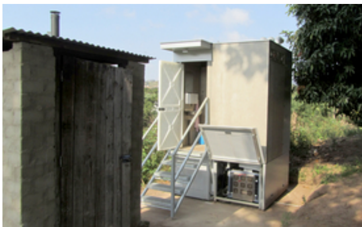
Die Blue Diversion Autarky Toilette im Test am Rand von Durban, Südafrika. Rechts vorne ist das Verdunstungsmodul sichtbar. (Michel Riechmann, Eawag)
