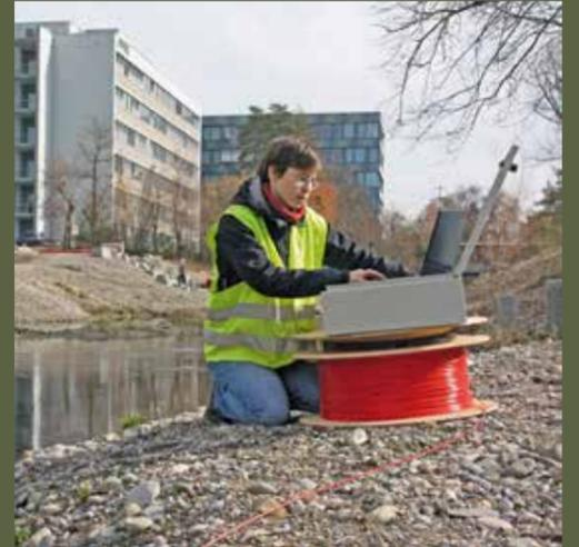
Ein 200 Meter langes, im Bach verlegtes Glasfaserkabel kann kleinste Temperaturunterschiede lokalisieren. Daraus schliessen die Forschenden auf die Wege des Wassers zwischen Bach und Untergrund. Die Betonröhren (rechts hinten) führen für Messungen bis 3 Meter tief ins Grundwasser. (Foto: Eawag, A. Bryner)
