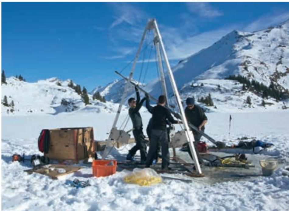
Entnahme eines Sedimentkerns aus dem gefrorenen Trübsee (NW). Damit werden historische Hochwasser rekonstruiert und Zusammenhänge zwischen besonderen Wetterlagen und Starkniederschlägen abgeleitet.
