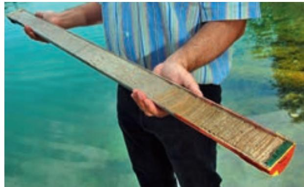
Mithilfe dieses Sedimentkerns aus dem Greifensee (ZH) haben Forschende der Empa und der Eawag gemessen, wie sich der Eintrag von bromierten Flammschutzmitteln entwickelt hat. Gut zu sehen sind die Jahresschichten.
