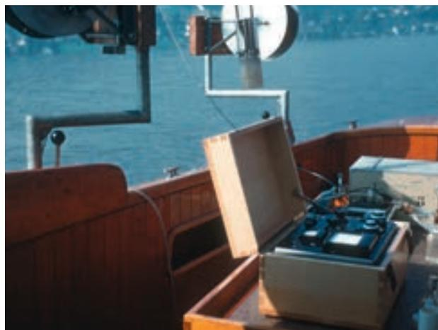
L'analyseur d'oxygène développé par Heinz Ambühl pour mesurer l'oxygène et d'autres paramètres (env. 1963).
