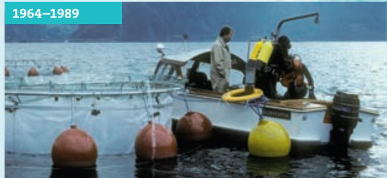
**Gloeocapsa**, 1964–1989, Bois, 6 personnes, 6,8 m de long, hors-bord de 85 CV, bateau côtier équipé d'une petite grue, utilisée surtout pour des prélèvements de plancton. Mis en œuvre dans le cadre d'un écosystème modèle (limnocorail) dans le lac des Quatre-Cantons. Également financé par la Fondation de l'économie pour la protection des eaux.
