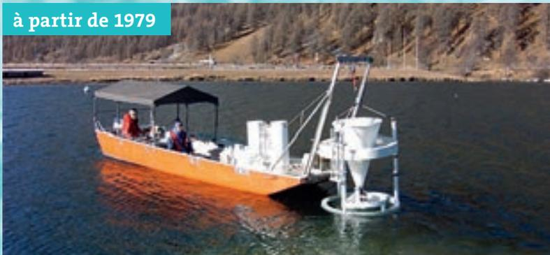
**Salm 1–3**, à partir de 1979. PRV, Meier Dintikon, 5 personnes, 7 m de long, 1,8 m de large. Mise en service en 1979. Utilisé pour des prélèvements sur les lacs les plus divers, comme ici lors de l’immersion de pièges à sédiments dans le lac de Silvaplana. Deux bateaux Salm ont été reliés temporairement pour former une plateforme afin d’installer une plus grande grue.
