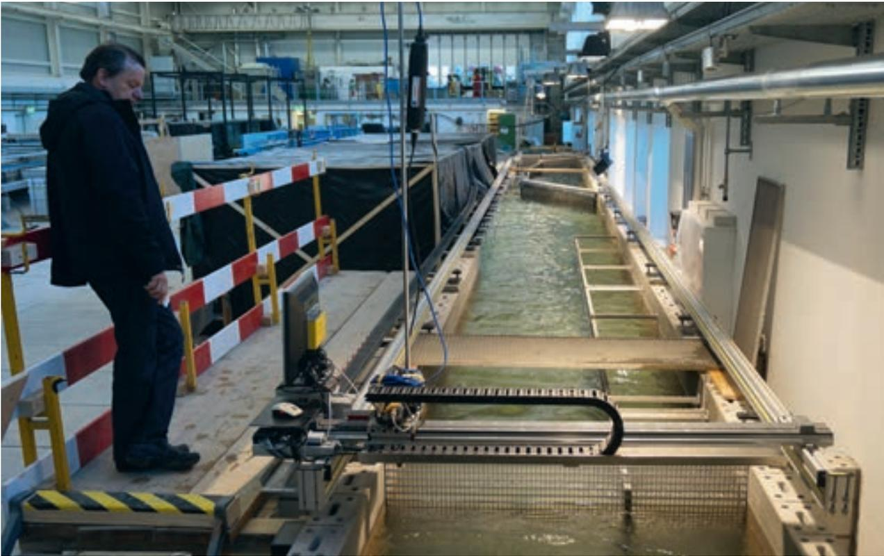
Dans un canal d'écoulement de la VAW<sup>7</sup>, on teste les différents dispositifs de guidage susceptibles de diriger les poissons dans une dérivation sans danger.
