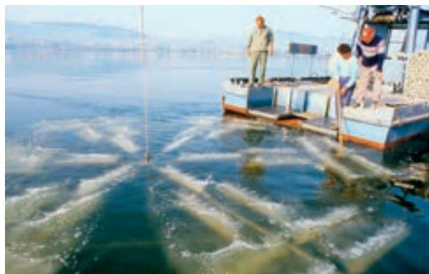
Des diffuseurs de ce type permettent d'injecter de l'air et, si besoin est, de l'oxygène pur au fond du lac.
