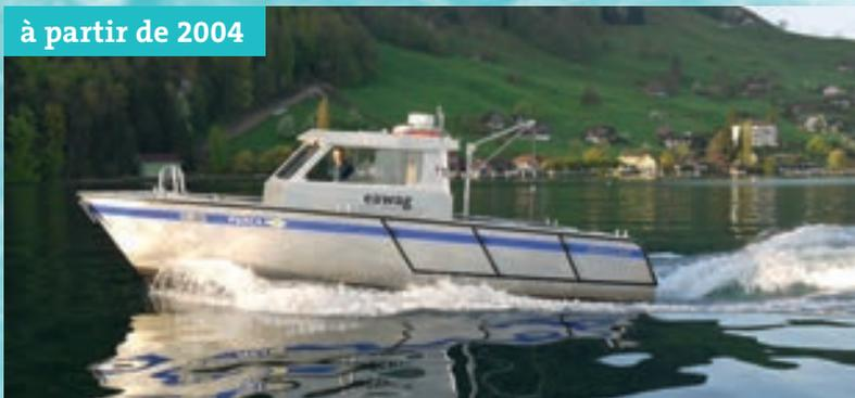
**Perca**, à partir de 2004. 9 m de long, 3 m de large, 3,3 t, 12 personnes ; Perca fluviatilis est le nom latin de la perche commune. Le bateau remplace le « Hans Bachmann » réformé. Il est avant tout utilisé lors des travaux pratiques en limnogéologie et lors de prélèvements sur le lac des Quatre-Cantons.
