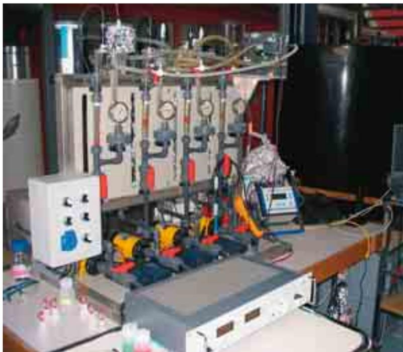
Elektrodialyse-Anlage, benutzt für die Laborversuche.
