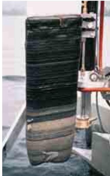
Ein Sedimentkern mit der Jahresschichtung. Schon in wenigen Zentimetern Tiefe steigt der Widerstand für den Stofftransport stark an.
