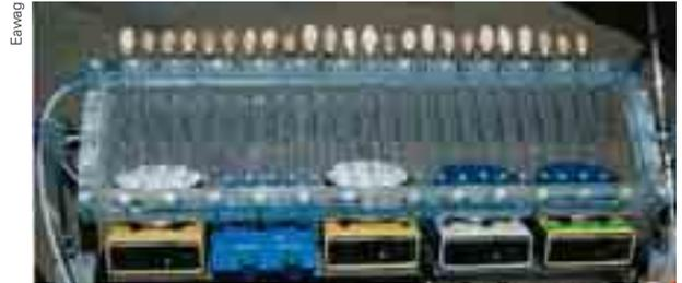
Bestrahlungsanlage für kontrollierte Sodis-Versuche. Die Wasserproben befinden sich in Quarzglasröhrchen (max. 25 Röhrchen) und können temperiert werden. Die Anlage kann in alle Richtungen gedreht und gekippt werden, um dem Sonnenstand zu folgen.
