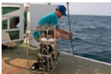
Eine Pumpe, die Proben aus der Tiefe hinaufbringen soll, wird zum Absenken am Stahlseil vorbereitet.
