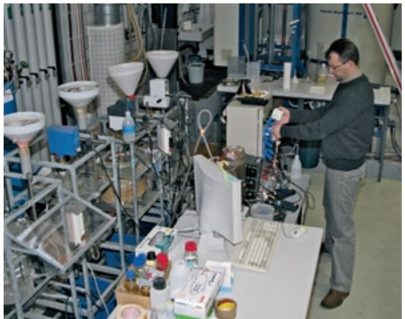
In dieser Versuchsanordnung laufen unter kontrollierten Verhältnissen dieselben Prozesse ab wie in den grossen Becken einer Kläranlage. Die Reaktoren erlauben eine Bestimmung der Abbauraten von Medikamenten in der Abwasserreinigung.
