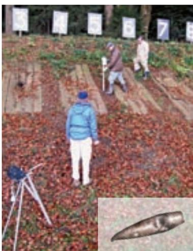
Entnahme der Bodenproben und Tiefenprofile im Kugelfang eines Schiessplatzes in Zusammenarbeit mit der ETH Zürich. Kleines Bild: Verschossene Gewehr-kugel.
