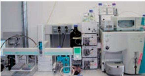
Analyse der aufkonzentrierten Wasserproben im Massenspektrometer.
