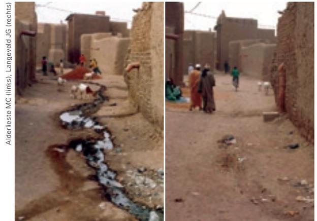
Eine Strasse in Djenné, Mali, vor und nach der Einrichtung von einfachen Versickerungssystemen für Grauwasser.
