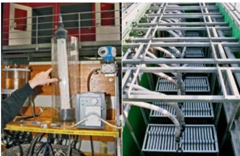
Ein Ultrafiltrationsmodul im Labormassstab an der Eawag und die gleichen Membranen (Porengrösse rund 40 nm) vor dem Praxiseinsatz in der Kläranlage des bayerischen Monheim. Das gereinigte Abwasser wird durch die Hohlfasern abgesaugt, feste Stoffe bleiben zurück.
